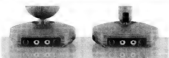
▲接器和发射器背面的端子是完全一样的，所以要小心不要掉转两者，否则便不能正常运作了。
